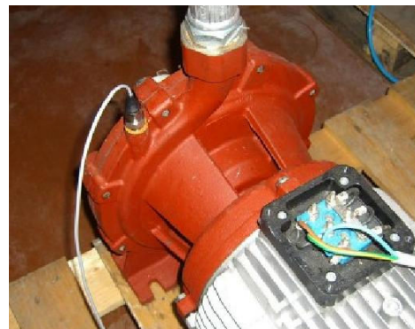
Obr. 4: Príklad montáže snímača do plniaceho otvoru čerpadla
