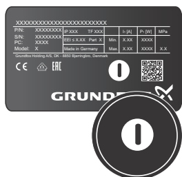
Obr. 36 Identifikácia hlavy hlavného čerpadla na typovom štítku
