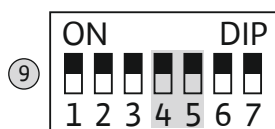
Fig. 18: DIP-spínač 2: Ukazovateľ servisného intervalu
