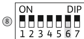
Fig. 17: DIP-spínač 1: Ochrana proti zatuhnutiu čerpadla
