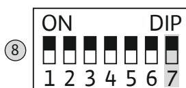
Fig. 16: DIP-spínač 1: interný bzučiak
