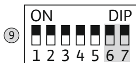
Fig. 10: DIP-spínač 2: Aktivácia čerpadiel
