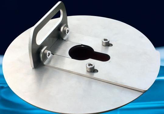
Montážní sada slouží pro profesionální montáž čerpadel do vrtů a je vyrobena z masivní nerezové oceli. Sada umožňuje jednoduchou montáž i demontáž čerpadla, snadné zavěšení na závěsné zařízení nebo lano. Sada obsahuje montážní sponu pro fixaci potrubí a zabraňuje vniknutí nečistot do vrtu. Nosnost max. 350 kg.
